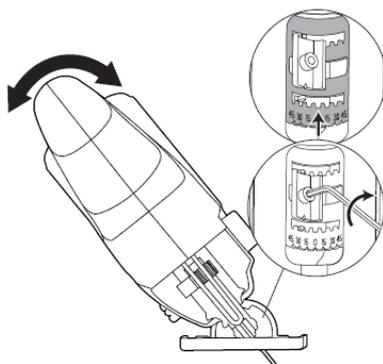
4. Используйте шестигранный ключ, чтобы затянуть винт, фиксирующий опорную подошву.
