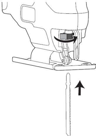
2. Установите пильное полотно в патрон-пилкодержатель и ролик.
